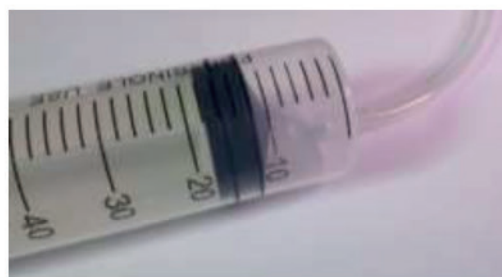
Fig. 12 : sur cet exemple, le piston est sur la graduation 12 mL, ce qui correspond à un volume total d'air égal à 15,4 mL ( 12+3,4=15,4 mL)
