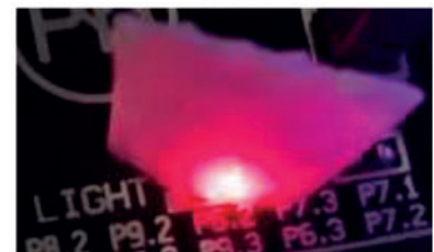
Fig. 12 : La diode rouge a été ici recouverte d'un papier calque pour mieux diffuser la lumière.
