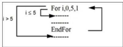
**Nota:** O comando **For** incrementa automaticamente a variável do contador para que a função ou o programa possa sair do ciclo após um determinado número de repetições.
