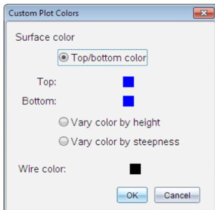
2. Selecione uma das três opções de cor da Superfície: **Cor superior/inferior**, **Variar a cor conforme a altura** ou **Variar a cor conforme o declive**.
