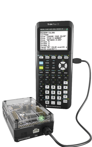
Hub collegato a calcolatrice grafica TI CE
