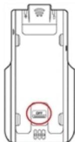
Dispositif de verrouillage en position ON (MARCHE).
