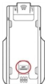
Dispositif de verrouillage en position OFF (ARRÊT).
