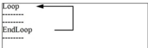
En général, vous insérez dans une boucle les commandes permettant au programme de sortir de celle-ci. Les commandes souvent utilisées à cet effet sont les suivantes : **If**, **Exit**, **Goto** et **Lbl**. Par exemple :
