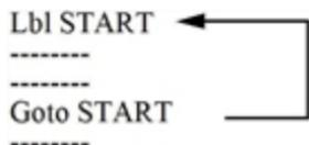
Comme dans le cas du bloc **Loop...EndLoop**, la boucle doit contenir des commandes permettant à la fonction ou au programme de sortir de celle-ci.
