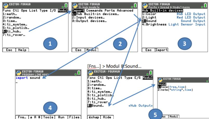
**Hinweis:** „Brightns“ ist ein „integriertes“ Objekt in TI-Innovator Hub.
