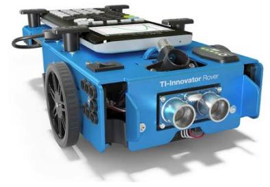
**Hinweis:** Mit dem Programm wird zunächst der TI-Innovator Hub programmiert, der seinerseits den TI-Innovator Rover *steuert*. Der Rover wird nicht direkt programmiert!
