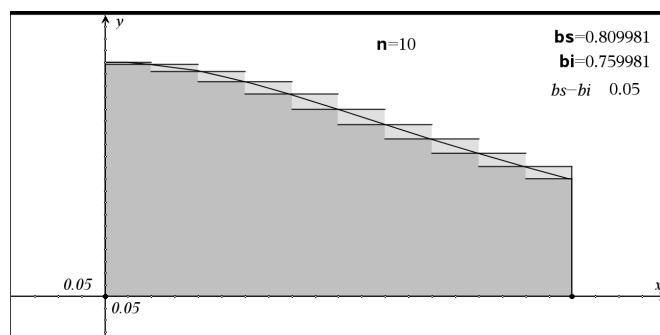
Visualisation géométrique de l'amplitude de l'encadrement : en ramenant tous les petits rectangles sur la première colonne on obtient un rectangle de dimensions  $\frac{1}{2}$  et  $\frac{1}{n}$ , donc d'aire  $\frac{1}{2n}$ .
