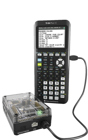
Hub collegato a calcolatrice grafica TI CE
