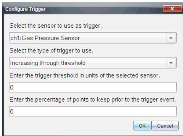
3. Seleccione el sensor de la lista desplegable **Seleccione el sensor que se utilizará como activador**.
