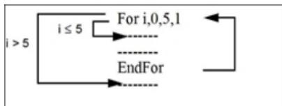
**Nota:** El comando **For** incrementa en forma automática la variable del contador, de manera que la función o el programa puede salir del bucle después de un cierto número de repeticiones.
