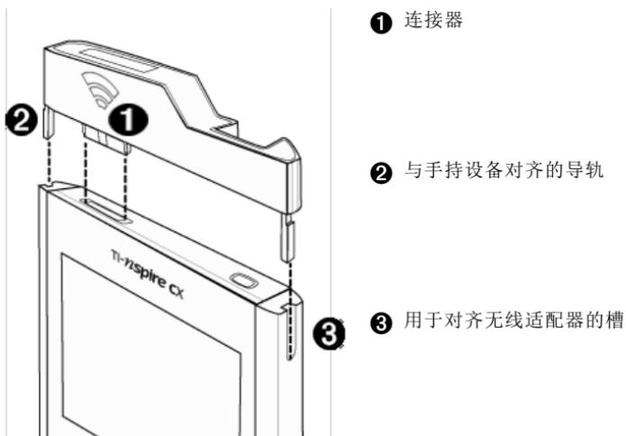
2. 将适配器滑动到位，确保适配器端的导轨滑入手持设备端的槽中。
