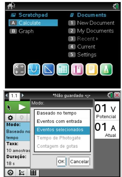
Antes de iniciar deve colocar os sensores a zero antes de os ligar ao circuito, para isso basta pressionar sobre o sensor e o écran ao lado aparece de imediato
