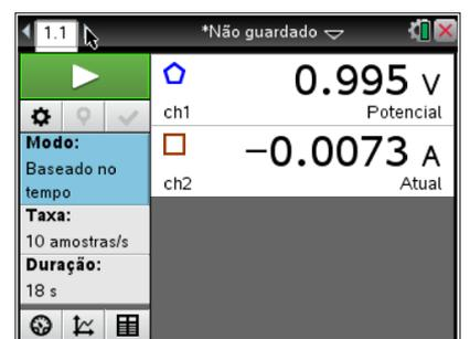
Avança no reóstato e repete o procedimento escrevendo posição 2, e prossegue até chegares ao final do reóstato. Para parar basta clicar no botão do canto superior esquerdo (parar recolha). Se quiseres repetir o ensaio sem apagares os dados anteriores pressiona o 3<sup>o</sup> botão do canto inferior esquerdo.
