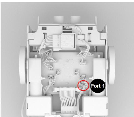
8. Inserte el cable suelto I<sup>2</sup>C en los rieles laterales.
