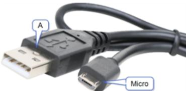
2. Inserte el microconector en el puerto **PWR** en el costado del Rover.
