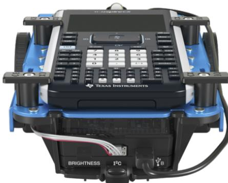
**Nota:** Con el TI-Innovator™ Hub insertado tiene acceso al sensor y a dos puertos.
