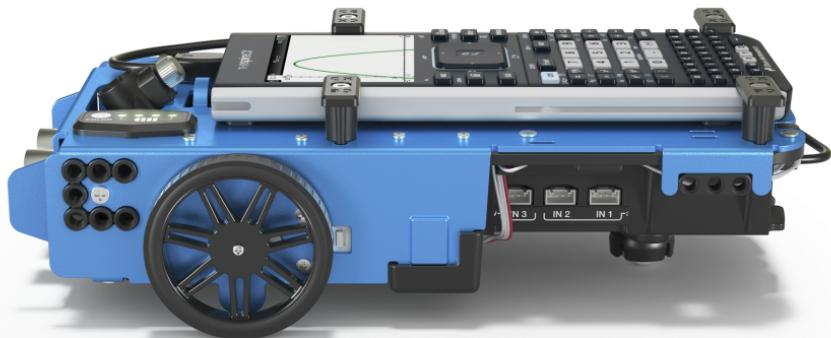
**Nota:** Con el hub insertado tiene acceso a los tres puertos para recopilar los datos o el estado de los módulos de entrada.
