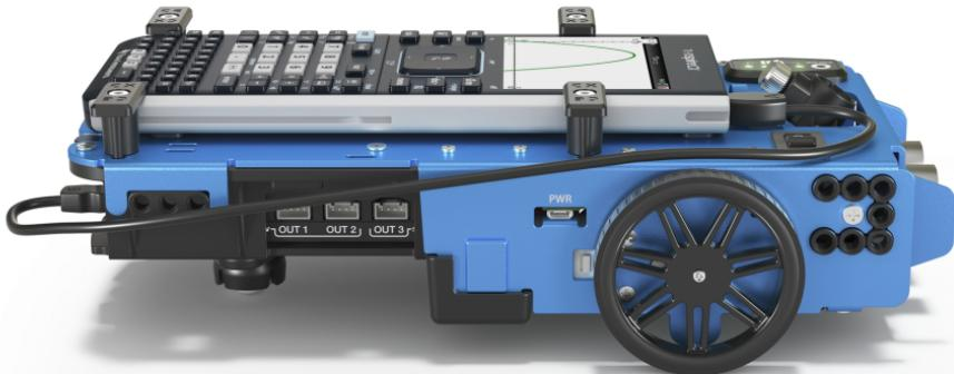
**Nota:** Con el hub insertado tiene acceso a los tres puertos para controlar los módulos de salida.
