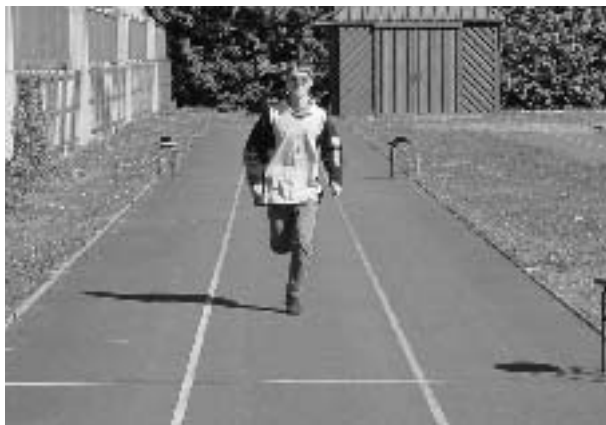
Die Lichtschranke an der Laufbahn: Die Start-Lichtschranke ist im Hintergrund, die Stopp-Schranke im Vordergrund.
