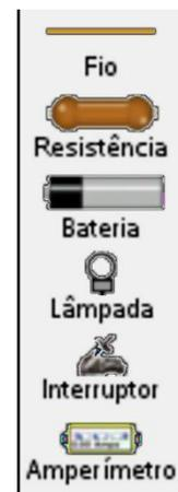
Também pode usar o amperímetro que se encontra na caixa de ferramentas e intercalar no circuito em série. O uso do amperímetro
